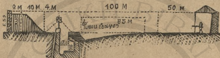
Εἰκὼν 12.— Ἐνταῦθα παραθέτομεν σχεδιάγραμμα τοῦ Σκοπευτηρίου μετὴν κρύπτην ὁρωμένην ἐκ τῶν πλαγίων.
